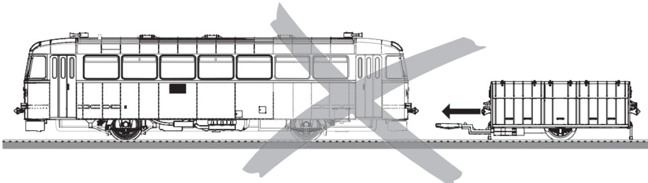
¡Recomendamos encarecidamente no acoplar en la vía el ferrobús con el remolque, sino encarrilarlos una vez acoplados!
