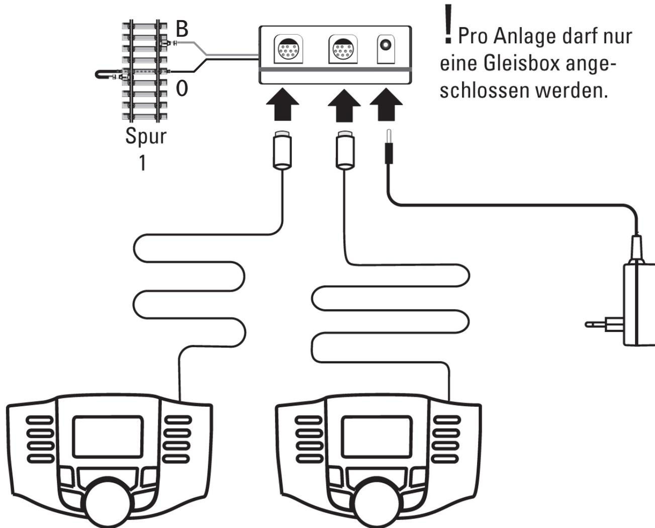
Zusammen mit einem m84-Decoder lässt sich die Schiebebühne einfach digital steuern.
