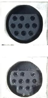
Die eingesetzten Geräte sollten auf verschmutzte Buchsen kontrolliert werden. Das linke Bild zeigt eine saubere Buchse, das rechte Bild eine verschmutzte Buchse. Verschmutzte Buchsen verursachen einen Kriechstrom, der die Kommunikation auf dem Märklin Bus stört. Sollten Buchsen verschmutzt oder feucht sein kann auch eine Reinigung unter Umständen nicht helfen. In diesem Fall muss das betroffene Gerät getauscht werden. Es sind alle benutzten und unbenutzten Buchsen zu kontrollieren.
