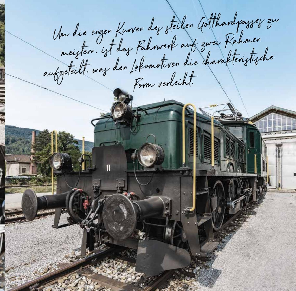
*Um die engen Kurven des steilen Gotthardpasses zu meistern, ist das Fahrwerk auf zwei Rahmen aufgeteilt, was den Lokomotiven die charakteristische Form verleiht.*
